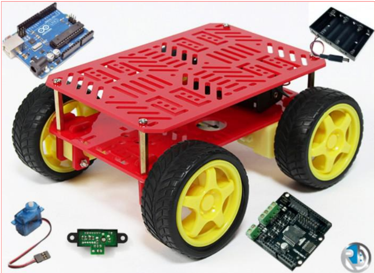
FIGURA 1: ROBOT BEGINNER KIT 4WD - ARDUINO UNO
