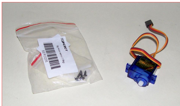
FIGURA 5: IL SUB MICRO SERVO 9G
